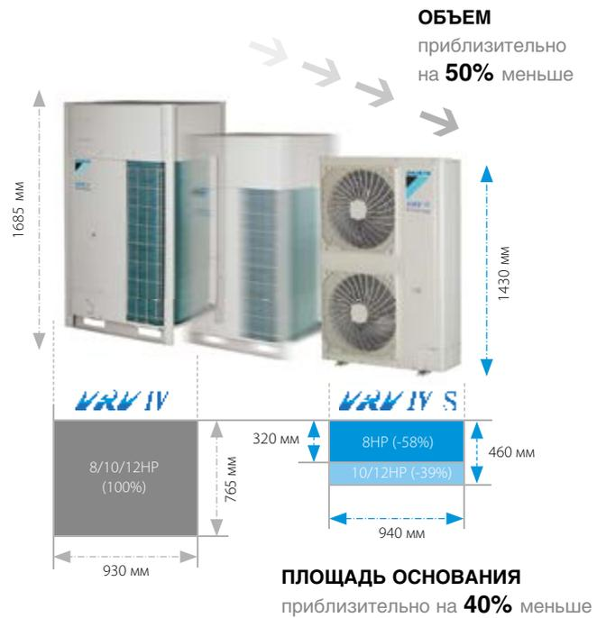
Компактные блоки в привычном корпусе с большой производительностью 8/10/12 HP занимают площадь на 58% (8 HP) и 40% (10/12 HP) меньше, чем аналогичные блоки систем VRV IV Heat Pump, вес ниже на 26%, а уровень шума всего 50 дБ(А), что более чем в 5 раз ниже.
