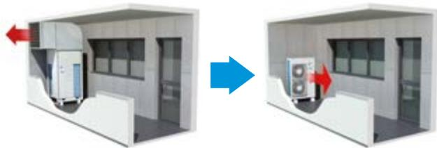
Благодаря новой форме корпуса и компактным размерам блоки большой производительности можно без дополнительных затрат размещать под козырьком, невысоким навесом, по причине меньшего веса их несложно поднять на крышу без привлечения специальной техники.
