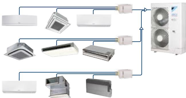
В системе можно использовать внутренние блоки VRV, либо через ВР-адаптеры стильные блоки бытовой серии: Emura, Perfera и другие, кроме того, возможно подключение вентиляционных установок и секции непосредственного охлаждения приточной установки.
